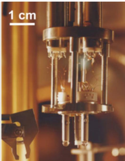
Figura 1: Esquema de un STM (izquierda) y fotografía del STM de ultra-alto vacío y de temperatura variable (40-400 K) completamente diseñado y construido en el LNM (Custance, 2003)
